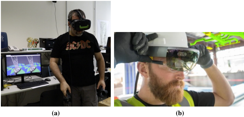
Figura 9.6: (a) un esempio di visore per VR (HTC VIVE); (b) un visore per AR (Microsoft HoloLens).
